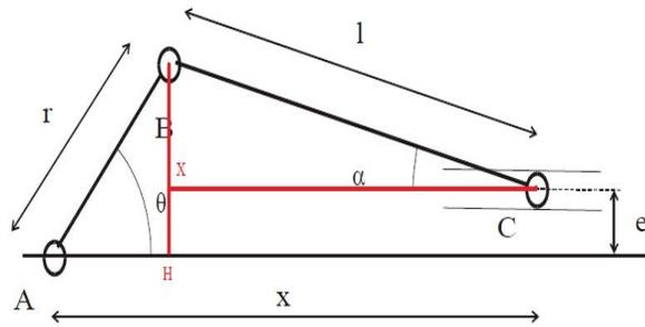
FIGURE C.2 – Calcul de la position d'un piston, annoté
