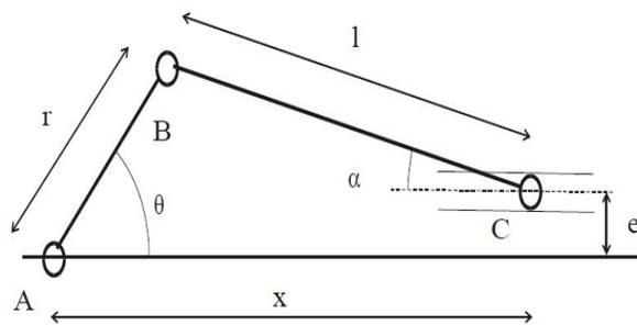
FIGURE C.1 – Calcul de la position d'un piston
