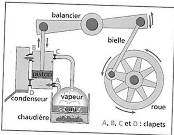
La machine à vapeur de James Watt a d'abord été utilisée pour pomper l'eau des mines, puis dans d'autres domaines industriels.
